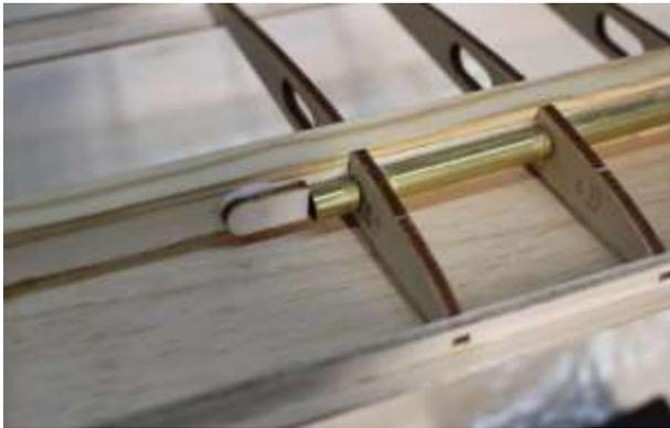
Aus Restmaterial einen Anschlag für den Tragflächenverbinder anfertigen und einleimen.
