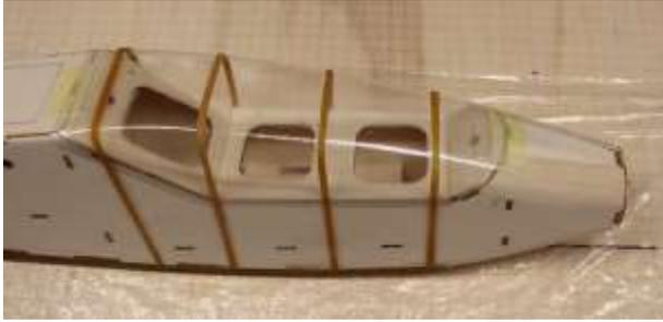
Ist man mit der Passung der Kabinenhaube zufrieden, Kabinenhaube mit Kunststoffkleber Ruderer L 530 mit Haubenrahmen verkleben.
