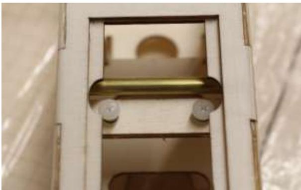
Führungsrohr für Tragflächensteckung (Messing Ø7×70 mm) mit Epoxy einkleben. Schrauben (Kunststoff M4×20) für Tragflächensicherung eindrehen.
