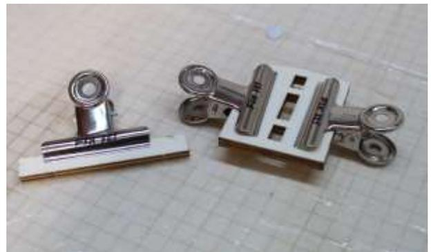
Höhenleitwerksmitteleil aus zweimal (E19), sowie Verbindungsteil aus zweimal (E18) verleimen.
