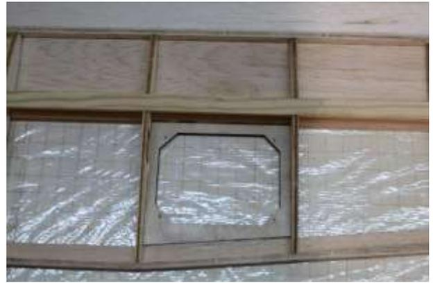
Einbaurahmen zwischen den Rippen (E12 und E13), sowie (E17 und F8) einleimen. Die Rahmen müssen bündig mit der unteren Beplankung abschließen.
