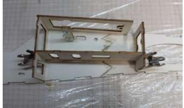
Spantengerüst aus (G10, G4, G12, G5 und Halter (E3/E4) auf einem Rumpfseitenteil E1/F2) verleimen
