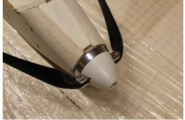
Luftschraubenblätter am Spinner montieren und Spinner auf Motorwelle befestigen.
