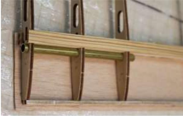
Führungsrohr für die Tragflächensteckung (Messing,  $\varnothing$  7×6 mm) in Rippen (D4 bis D6) mit Epoxy einkleben.
