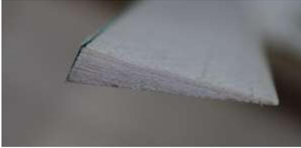
Vorderkante Wölbklappe 15° schräg schleifen.
