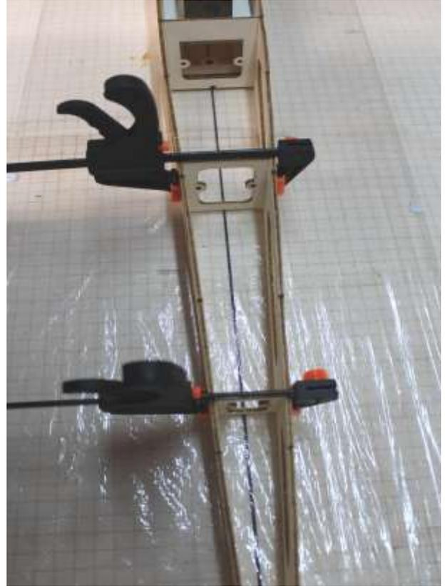
Spanten (G9 und G11) zwischen den Rumpfseitenteilen
