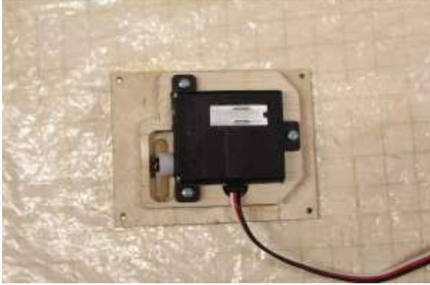
Servo für Querruder und Wölbklappen in **Servorahmen # C8782** schrauben.
