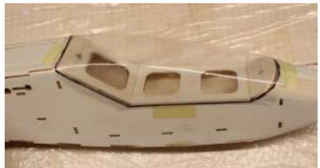
Kabinenhaube aufsetzen und mit Klebestreifen sichern. Den Umriss des Haubenrahmens mit Filzstift auf die Kabinenhaube abzeichnen.
