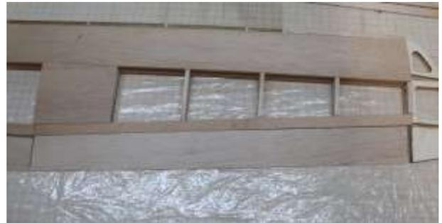
Querruder und Wölbklappe (Dreieckleiste Balsa 40×8 mm) auf Länge schneiden.
