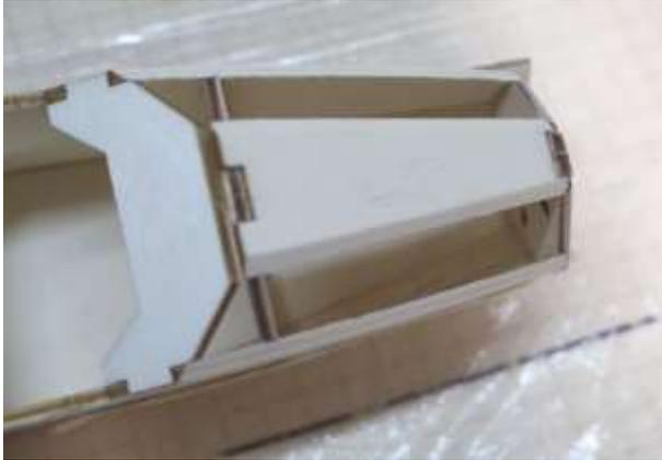
Rumpfteile (E1), untere Rumpfbeplankung (G3) und Beplankungsteil für Rumpfspitze (E7) den 45°-Schrägen der Spanten entsprechend schräg schleifen.
