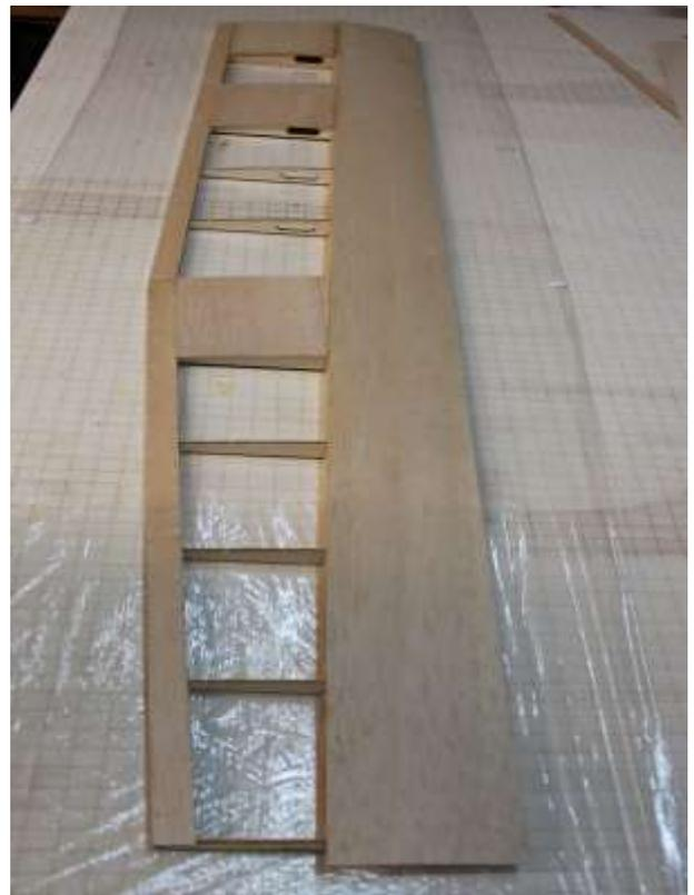
Obere Nasenbeplankung (Balsa 1,7 mm), Endleistenbeplankung (K1 und K2) und Beplankung über den Servorahmen zwischen den Rippen (E12/E13 und E17/F8) verleimen.
