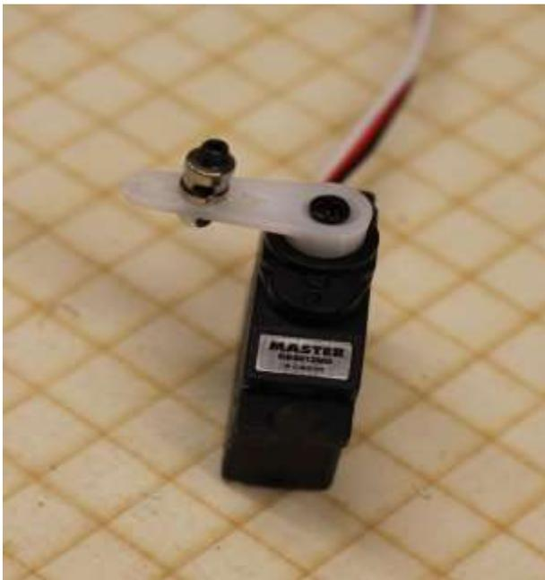
Bohrungen im Servoarm auf  $\varnothing 2$  mm aufbohren.
