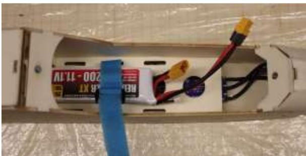
Klettschlaufenband durch die seitlichen Längsslitze des Akkubretts fädeln. Akku auf Akkubrett legen und mit dem Klettschlaufenband verzurren.
