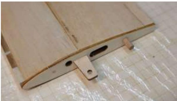
Überstände an Wurzelrippe (D4) und Endrippe (F12) abschneiden und plan schleifen.
