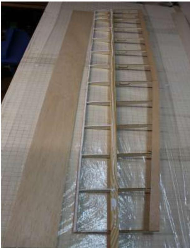
Nach dem Trocknen die Fläche vom Baubrett abnehmen und die untere Endleistenbeplankung aus (K1 und K2), sowie die untere Nasenbeplankung (Balsa 1,7 mm) auflegen, ausrichten und verleimen.
