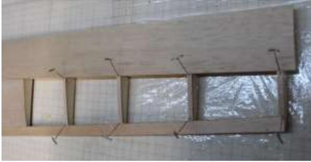
Rippenaufleimer (K, Balsa 1,7×5 mm) auf Ober- und Unterseite anpassen und verleimen.
