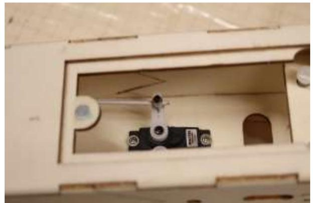
Länge der Seele der Bowdenzüge bestimmen und ablängen. Die Bowdenzüge werden in die Bohrungen der Klemmstücke eingeführt und mit der Schraube gesichert.
