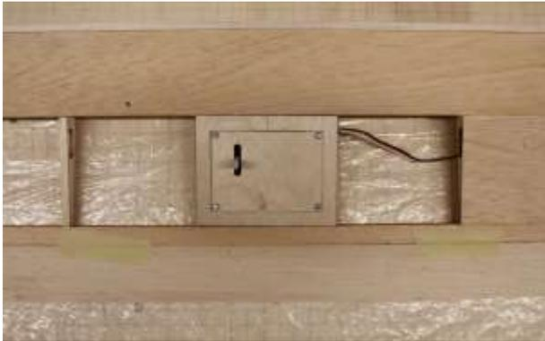
Deckel mit Servo im Einbaurahmen mit 4 Schrauben (2,2×6,5 mm) montieren.
