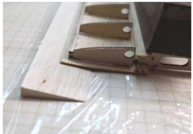
Um die Beplankung an die Wölbung der Rippen anzupressen, wird als Hilfsmittel unter die Hilfsnasenleiste (I2) die Dreieckleiste (Balsa 8×40 mm) (für die späteren Ruderklappen) geschoben.
