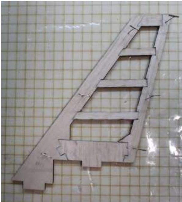
Das Seitenleitwerk aus den Teilen (B1 bis B6 und B8) zusammensetzen und verleimen.
