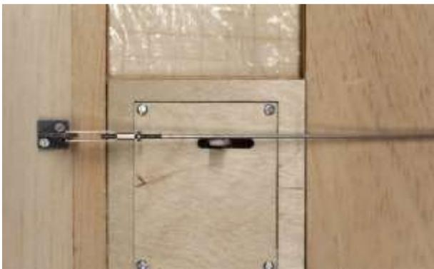
Anlenkgestänge aus Stahldraht (Ø1,8 mm), M2-Kontermutter und M2 Gabelkopf komplettieren.
