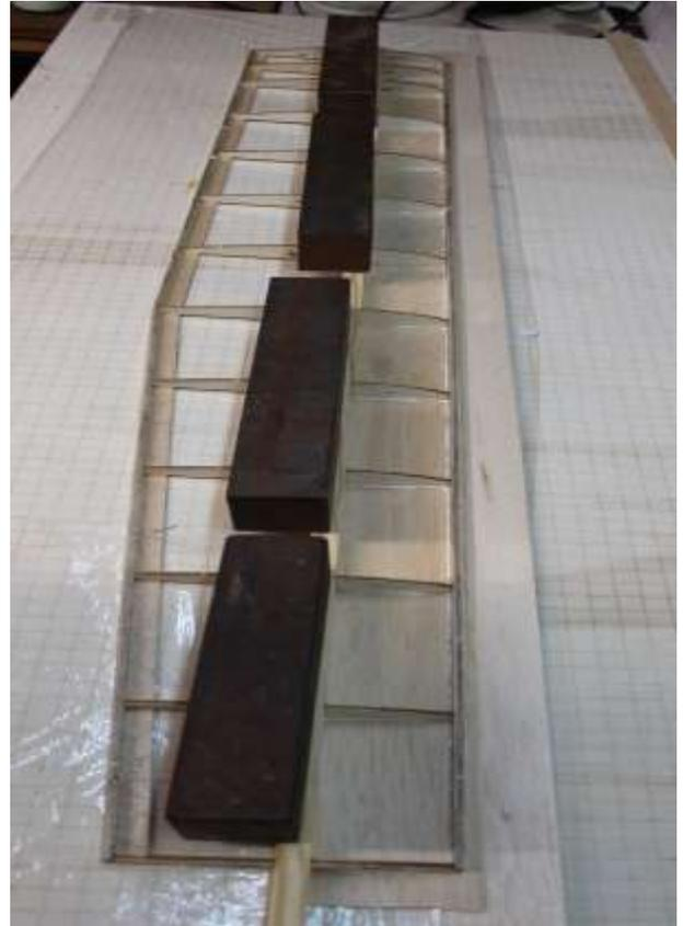
Zum Trocknen die Fläche wieder mit der Unterseite auf das Baubrett legen. Darauf achten, dass die Fläche plan aufliegt. Fläche mit Gewichten beschweren.
