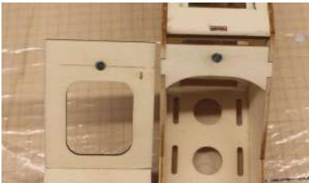
Magnete in Teile (E9 und E5) mit Sekundenkleber einkleben.
