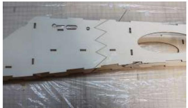
Zweites Rumpfseitenteil (E1/F2) auf Spantengerüst einleimen.
