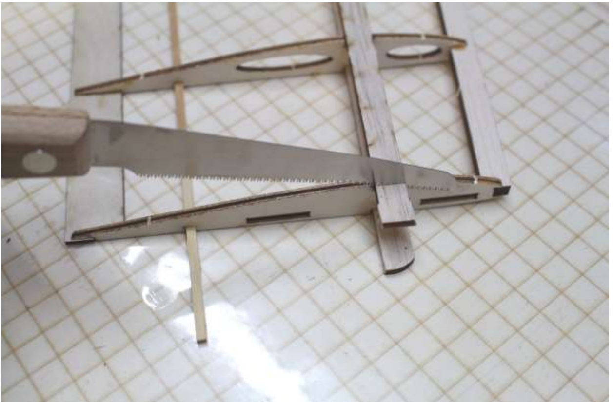
Nach dem Trocknen des Klebers die Überstände an beiden Seiten entfernen und plan schleifen
