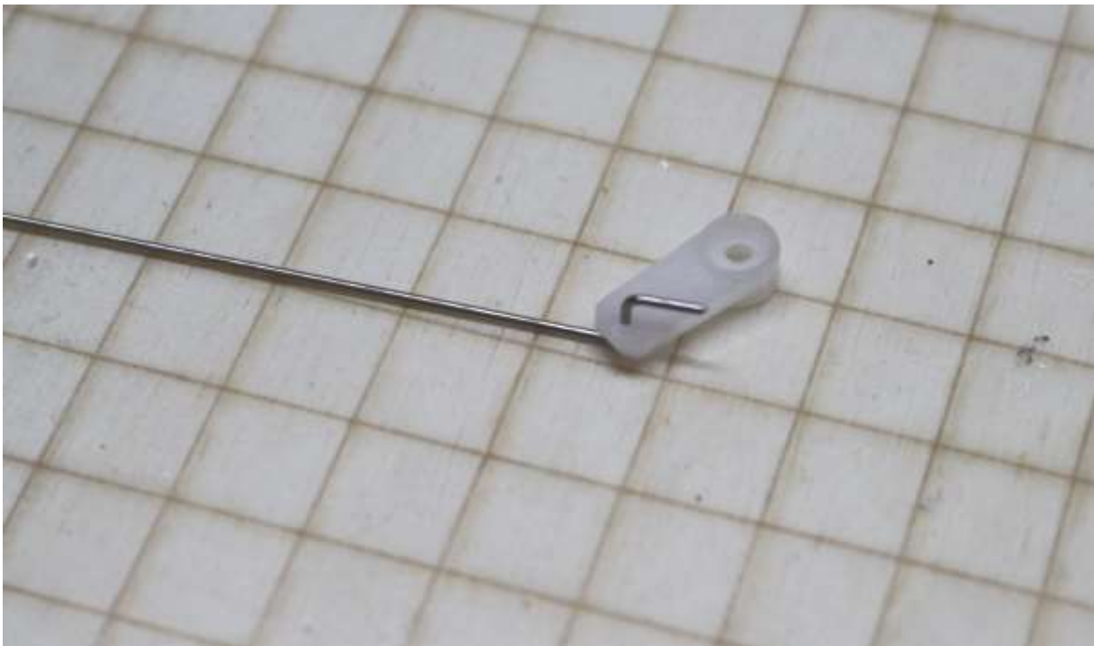
Anlenkungsdraht (Stahldraht \varnothing 0,8 mm) an einem Ende Z-förmig biegen und am Servohebel einhängen
