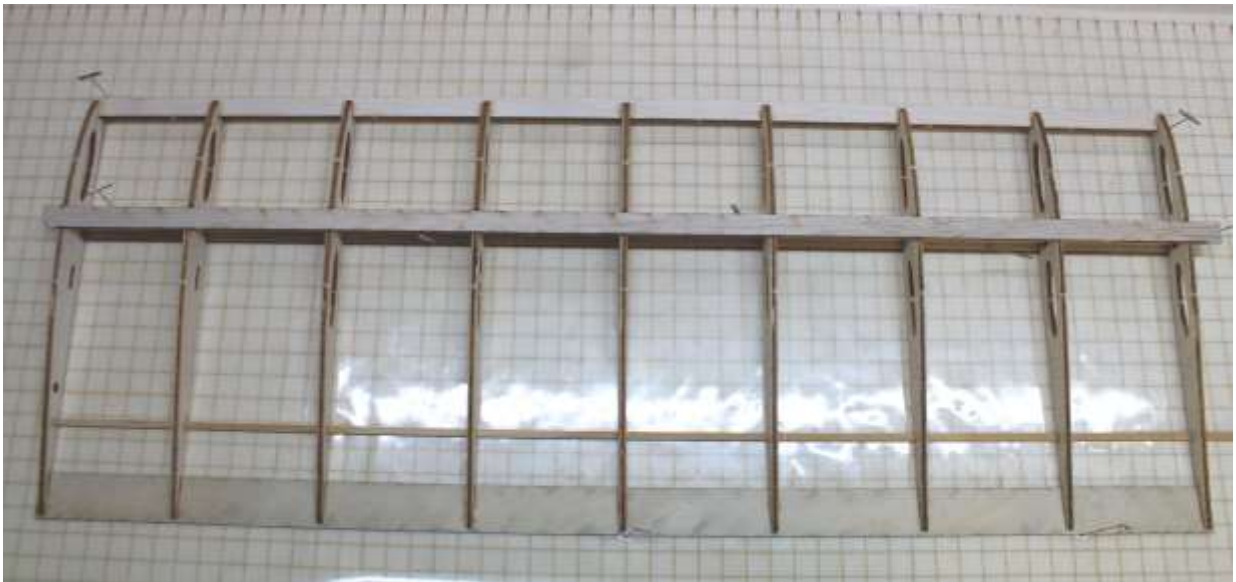
Oberen Hauptholm (Balsa 10×3×510mm) einkleben
