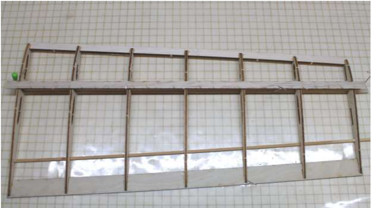
Oberen Haupttholm (Balsa 10×3×410) einkleben
