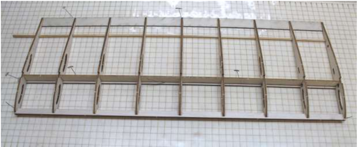
Nasenleiste (D1) einfädeln und verkleben
