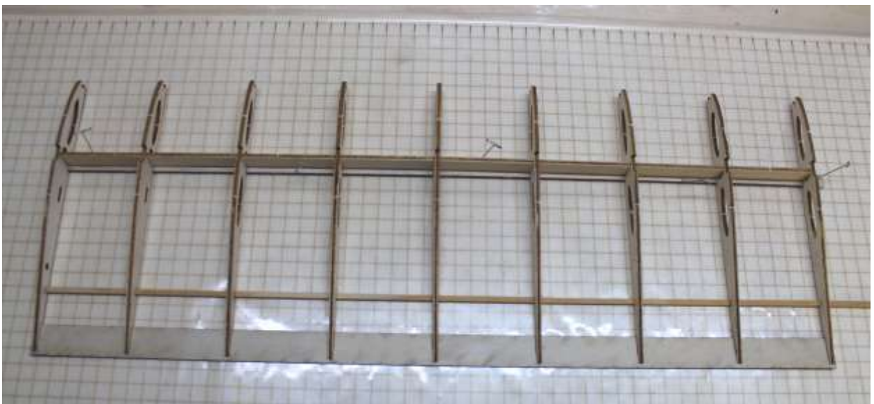
Endleiste (C1) an Rippenenden schieben und verkleben
