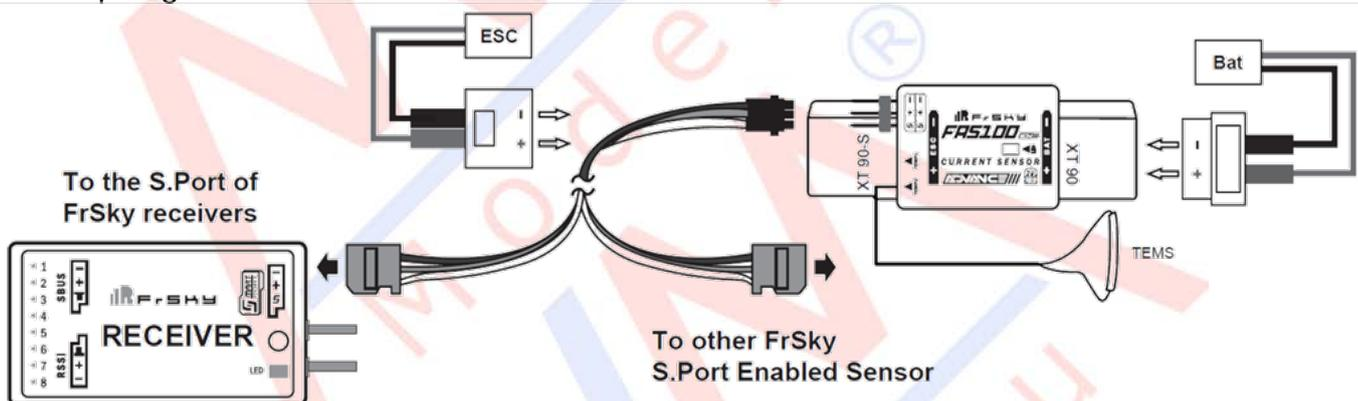
**Achtung:** Befestigen Sie den FrSky-Stromsensor – FAS100 ADV auf einer geeigneten Oberfläche der Flugzeugzelle, fern von Wasser, Vibrationen oder Kraftstoff.
